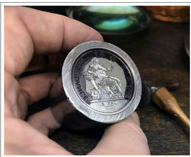
Matrice d'avers en cours de finition
