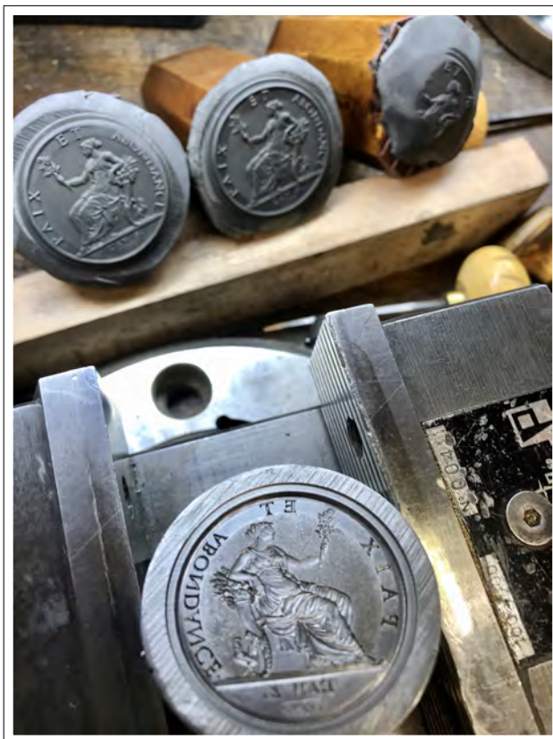
La matrice et empreintes en pâte à modeler effectuées à différentes étapes de la finalisation
